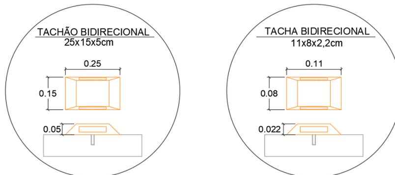
As tachas deverão ser instaladas a cada 2,50m, como divisores de pista e nas bordas da pista próximo dos acostamentos com largura de 2,40m e 0,30m. Nos acostamos com largura de 1,20m deverão ser instalados tachões a cada 1,00m.
