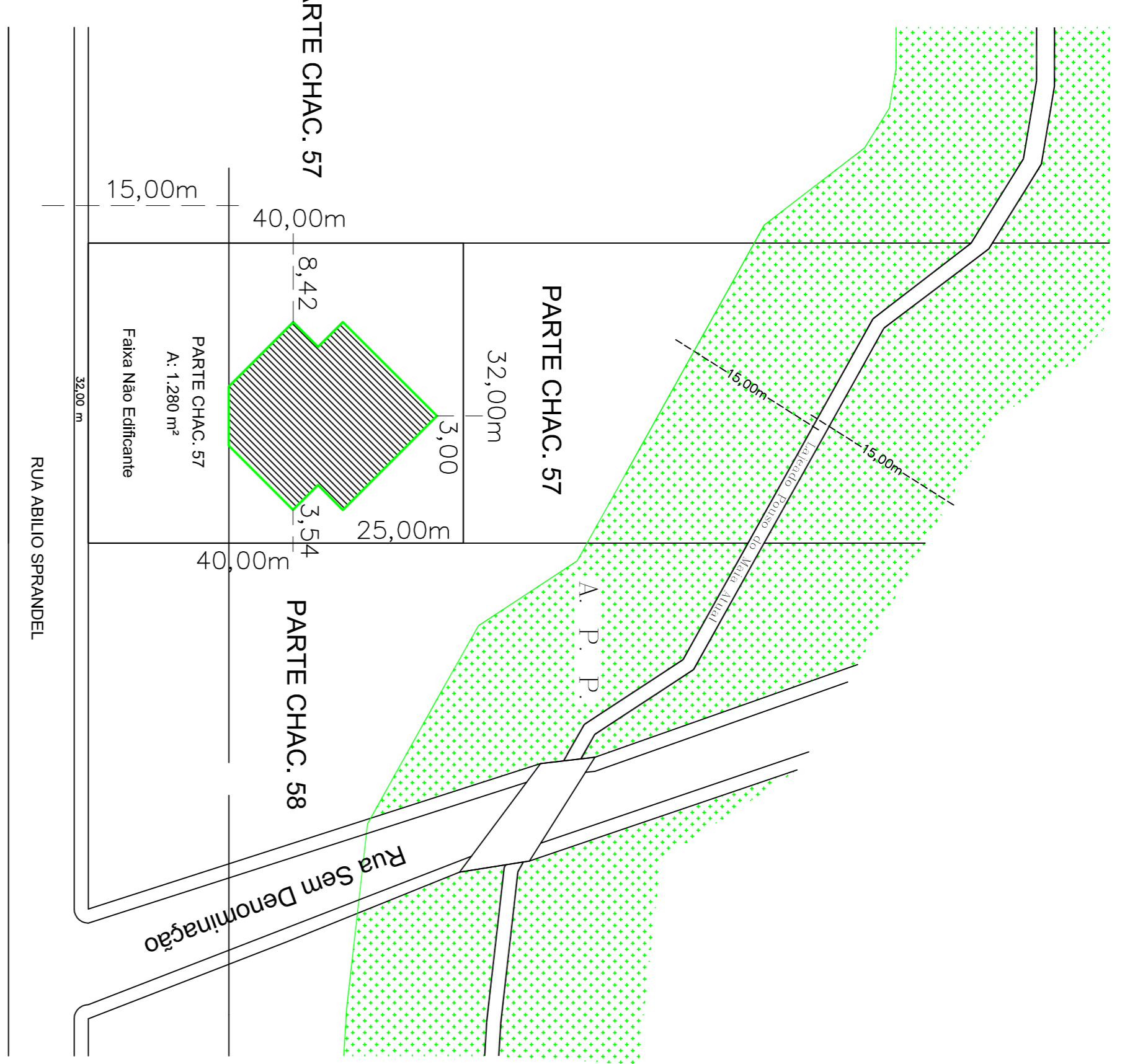
PLANTA SITUAÇÃO E LOCAÇÃO ESC.: 1:500
