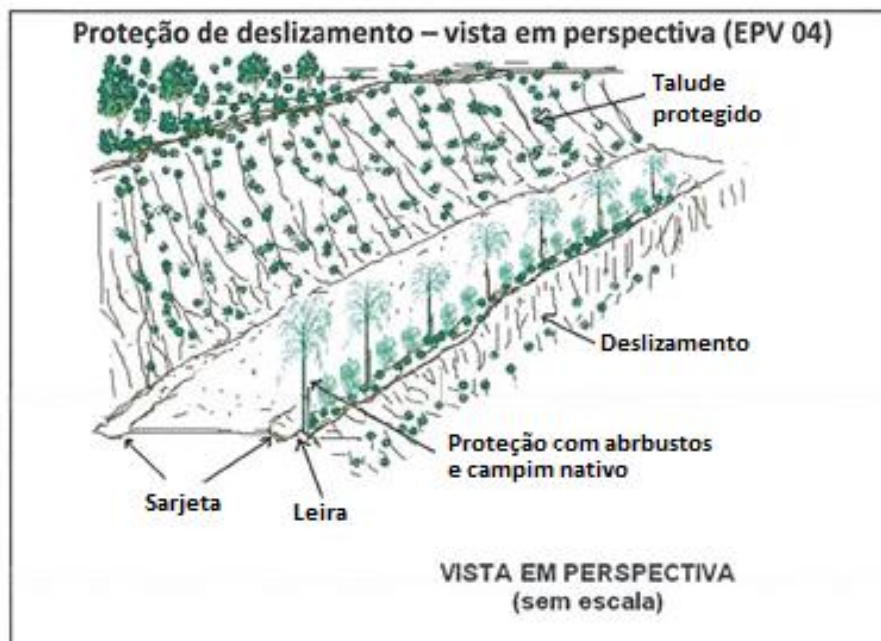
Figura 13 – Proteção de deslizamento – vista em perspectiva (EPV 04)
